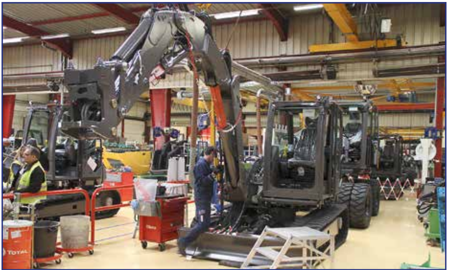
Mecalacin tehdas Ranskassa valmistaa kahdesta neljään konetta kolmen eri kokoonpanolinjan avulla. Puomit liitetään koneisiin viimeisenä vaiheena ennen laatukontrolliin siirtämistä.
